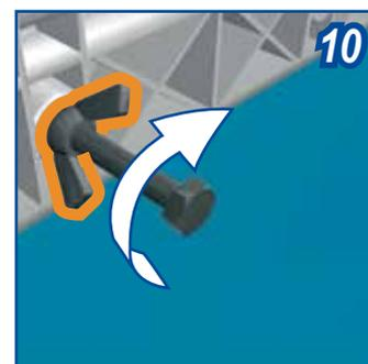
Enfin, serrez manuellement et fermement les papillons.
