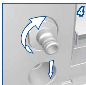
Orientez le raccord rapide vers le bas (pour les prises robot sur skimmer).
