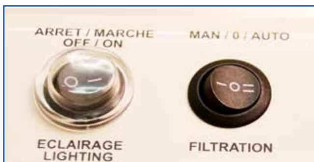
Démarrez la filtration sur le mode manuel et laissez-la fonctionner 24 h.
