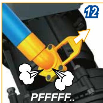
Purger la pompe de son air en débranchant doucement la surpression (rebrancher lorsque l'eau jaillit).
