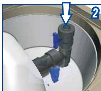
Insufflez de l'air dans le circuit (à l'aide d'un aspirateur inversé par exemple).
