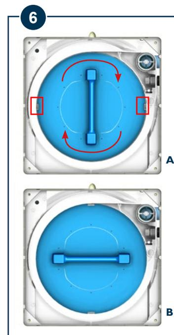
Mettez la poignée du couvercle du panier à la verticale (A) de façon à le passer dans les encoches puis mettez la poignée du couvercle à l'horizontale pour le verrouiller (B).
