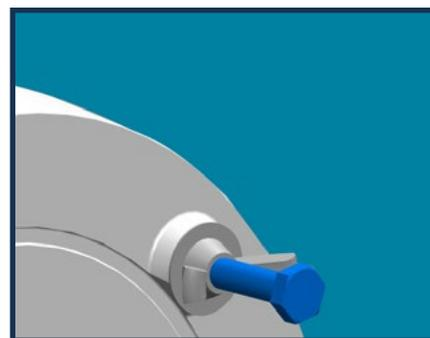
Insérez l'ensemble des vis dans les trous. Serrez les vis à l'aide d'une clé de 10 et ce jusqu'à la butée.
