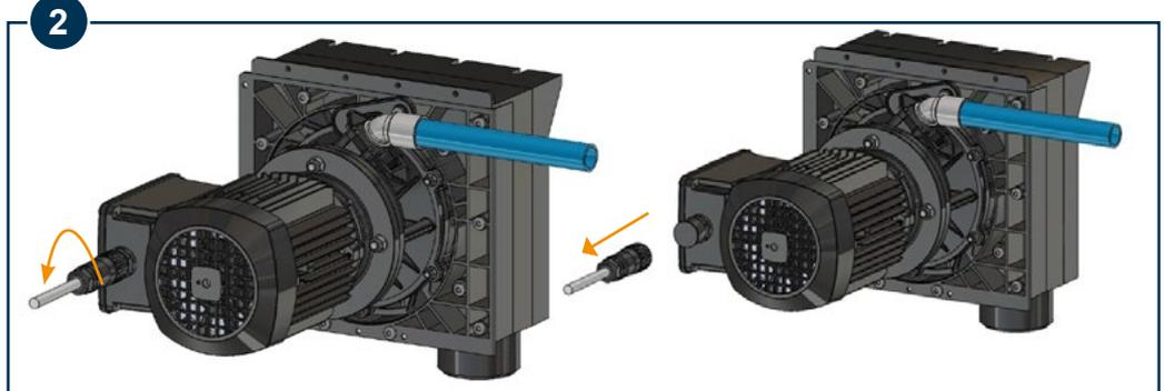
Déverrouillez le connecteur en tournant la bague. Débranchez le connecteur du câble sur le boîtier électrique de la pompe.
