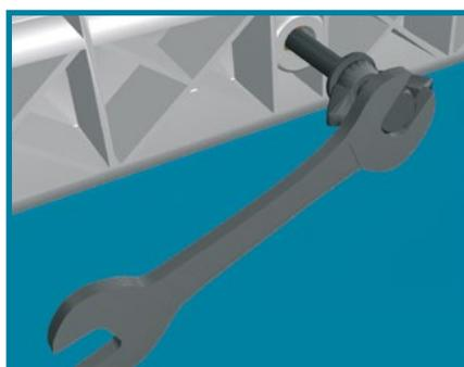
Serrez les vis à l'aide d'une clé de 10 et ce, jusqu'à la butée.
