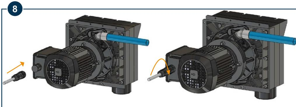
8 Raccordez le connecteur du câble sur le boîtier électrique de la pompe. Verrouillez le connecteur en tournant la bague.
