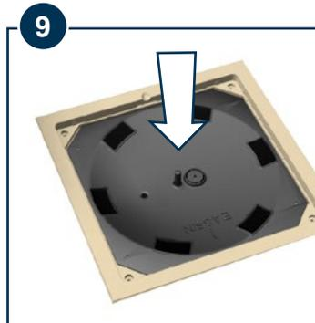
Replacez l'isolant acoustique en gardant l'orientation « bassin » vers le bassin et en glissant le tuyau d'évacuation dans le trou du compartiment moteur. Refermez et verrouillez le compartiment.
