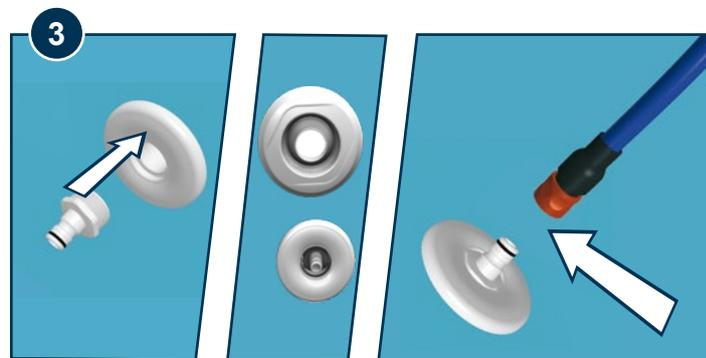
Vérifiez la propreté de votre crépine et sa bonne mise en place. Déballiez le balai de nettoyage et vissez la prise balai sur l'arrivée de surpression ainsi que les embouts sur le tuyau du balai.
