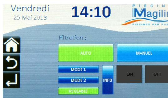
Le mode réglable dispose également de la possibilité d'avoir 2 paramétrages différents selon la température de l'eau pour s'adapter aux besoins de filtration de votre piscine. Dans ce mode, la température de l'eau peut être définie par l'utilisateur.
