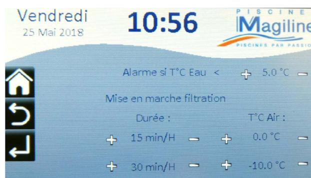
Par défaut, si la **température d'air** descend sous la consigne de 0°, la pompe tournera 15 minutes toutes les heures. Si la **température d'air** descend sous -10°, la pompe tournera 30 minutes toutes les heures.
